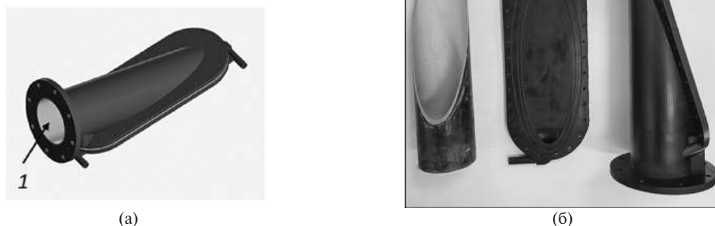
Рис. 1. Разработанная 3D-модель калориметра с входным волноводом диаметром 80 мм: а — волноводная вставка 1 ; б — подготовленные к сборке составные части фотополимерного калориметра: волноводная вставка, крышка и корпус
