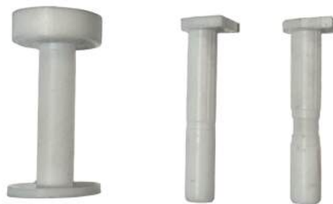
Рис. 4. Оснастки для намотки соленоида, измерительной системы и калибровочной катушки
