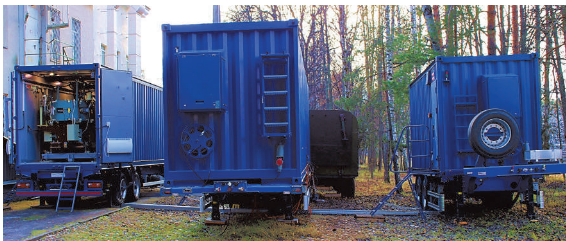
Рис. 1. Мобильный генератор гамма-излучения нового поколения: слева — ускорительный модуль, по центру — модуль управления и контроля, справа — модуль импульсного питания электромагнита
