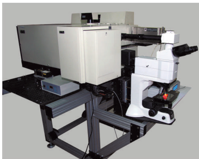
Рис. 1. Общий вид модернизированного спектрометра комбинационного рассеяния Jobin Yvon U1000
