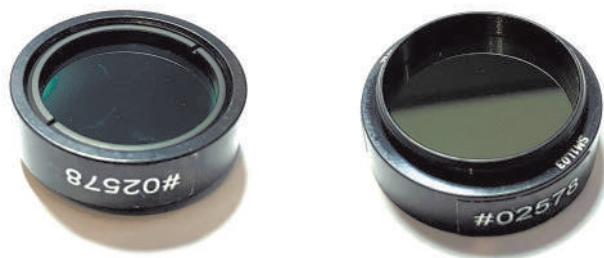
Рис. 1. Фотография германиевого фильтра Ge D2 5.4×4.8 мм HR Filter BBAR 8–12 мкм с обеих сторон
