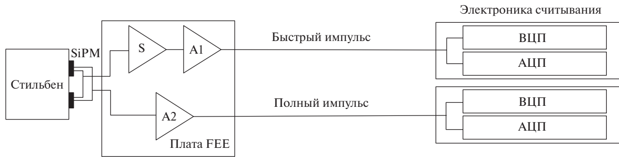
Рис. 3. Схема нейтронного канала считывания: SiPM — сборка из четырех кремниевых фотоумножителей, S — формирователь формы импульса путем дифференцирования, A1 — быстрый усилитель, A2 — транзисторный усилитель
