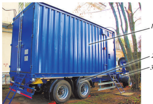
Рис. 4. Система транспортировки, эксплуатации и хранения МИПЭ: 1 – двадцатифутовый контейнер, 2 – полуприцеп, 3 – подкатная тележка
