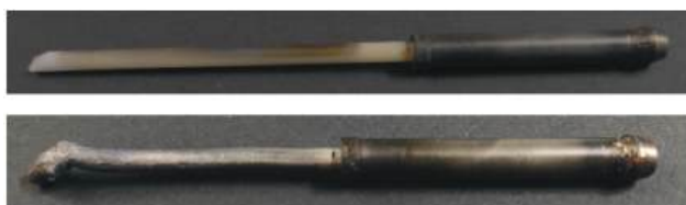
Рис. 1. Образцы \text{Al}_2\text{O}_3 (верхний) и \text{Al} (нижний) после эксплуатации.
