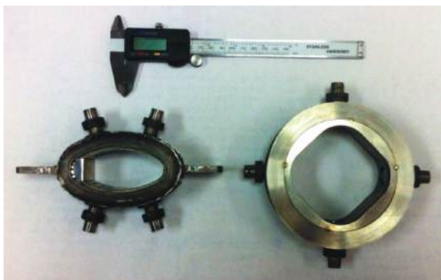
Рис. 1. Пикап на накопительном кольце: эллиптический (слева), круглый (справа).
