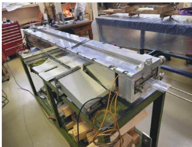
Рис. 1. Общий вид магнитной системы сверхпроводящего вигглера с полем 2.7 Тл для станции 1–3.
