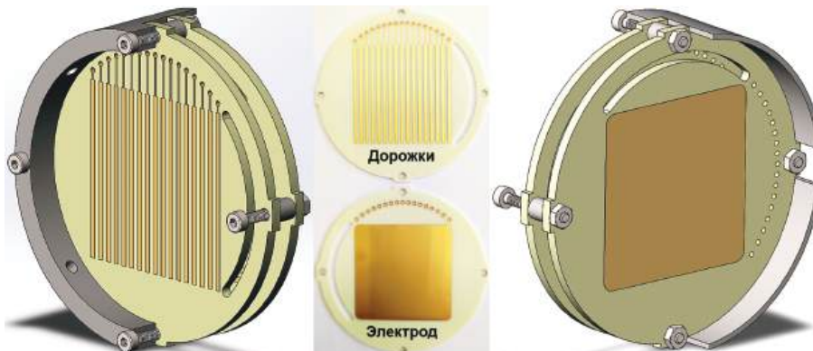
Рис. 4. Модель МЛП и фотография платы.
