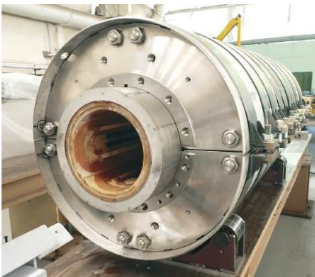
Рис. 5. Обмоточный СП-блок с магнитопроводом в обечайке гелиевого сосуда квадруполь FFS.
