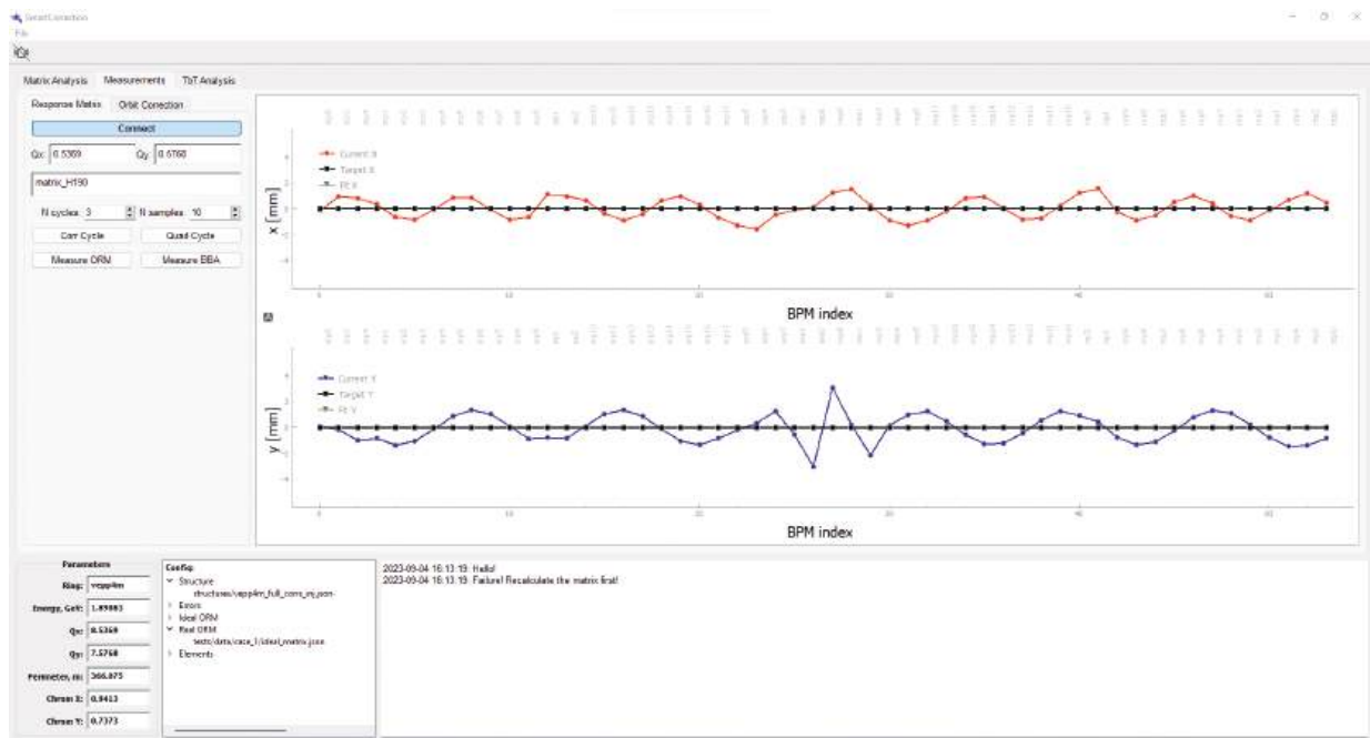
Рис. 5. Интерфейс взаимодействия с ускорителем: получение данных с ДПП и управление магнитными элементами.
