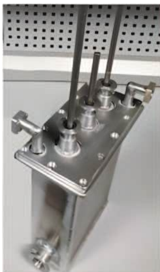
Рис. 13. Криогенный мезитиленовый модератор, разработанный для КИН DARIA.
