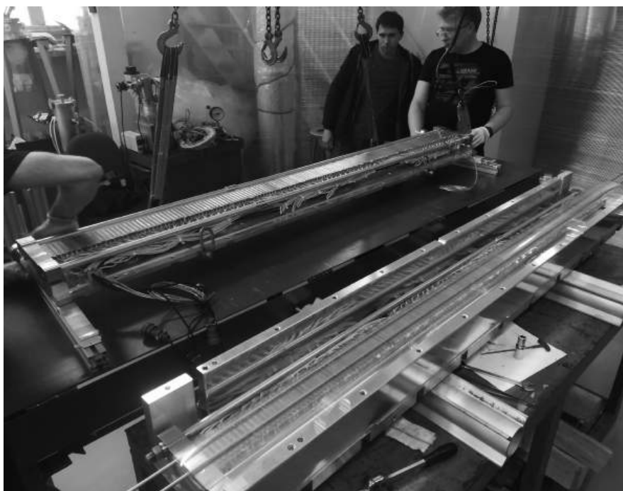
Рис. 3. Внешний вид вигглера с периодом 27 мм и полем 2.7 Тл в процессе сборки.
