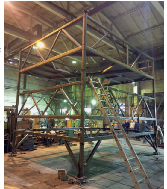
Рис. 8. Площадка обслуживания для высоковольтной системы: а – чертеж с установленными баками, б – фотография площадки в процессе изготовления перед покраской.
