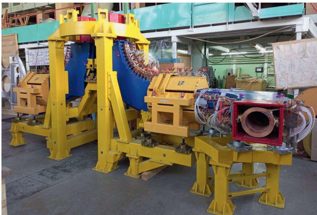
Рис. 2. Частичная сборка транспортного канала нижнего охладителя (элементы под высоковольтным баком).
