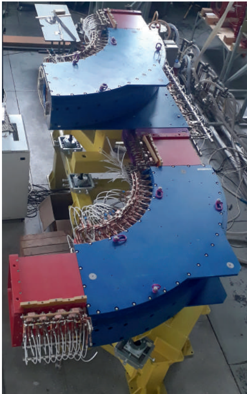
Рис. 3. Сборки участков транспортных каналов с горизонтальными поворотами.
