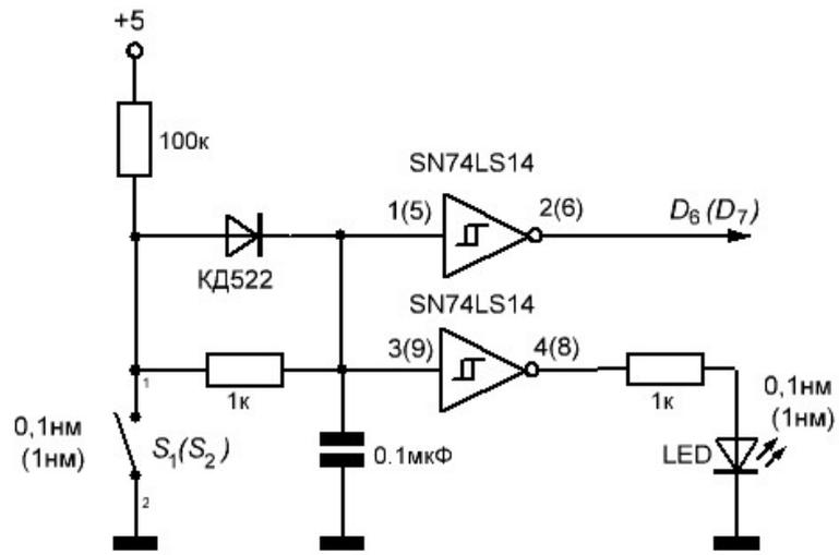
Рис.1. Принципиальная схема регистрации реперных сигналов.
