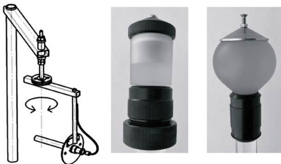
Рис. 4. Схема станда для исследования угловых характеристик излучателей (слева), фотографии конусного и сферического излучателей (справа).
