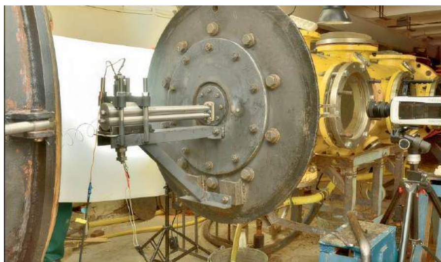
Рис. 4. Внешний вид двухствольной метательной установки на гидробаллистическом стенде.
