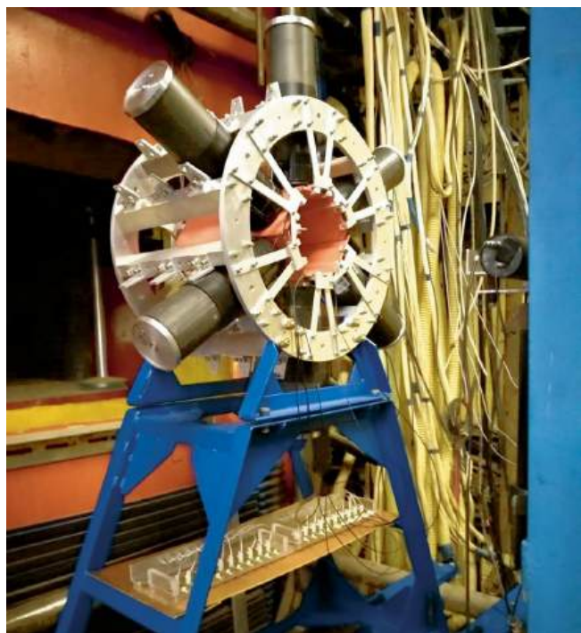
Рис. 7. Общий вид мишенного узла установки Гиперон+ на 18 канале У-70: красным цветом показаны продольные счетчики вето-детектора заряженных частиц, черные тубусы — сцинтилляционные счетчики на основе кристаллов NaI и BGO, внизу видна панель с усилителями для SiPM.
