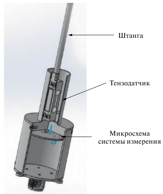
Рис. 11. 3D-модель угломера с указанием основных элементов.
