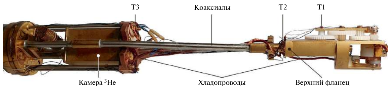
Рис. 2. Фотография устройства, смонтированного на СВЧ-спектрометр, совмещенный с криостатом откачки ^3\text{He} ; T1, T2 и T3 – термометры.
