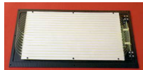
Рис. 10. Фото общего вида счетчика без светоотражающей и светозащитной обертки: сцинтилляционная пластина с WLS-волоконными, двумя SiPM, к которым присоединены торцы волокон, и электронный модуль.
