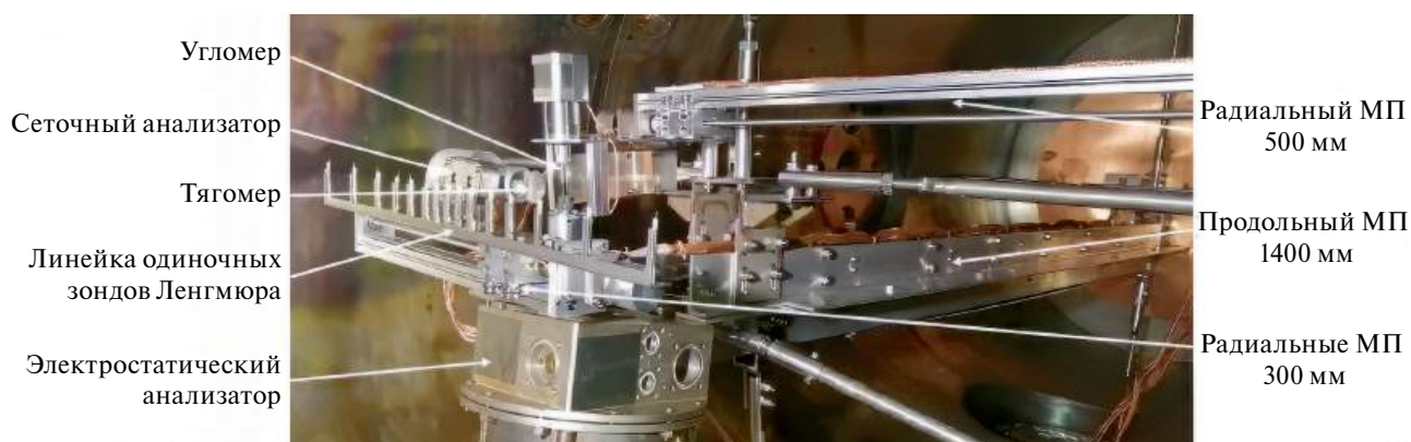
Рис. 9. Фотография диагностических устройств для измерения параметров плазмы и МП в откачном объеме стенда ПН-3 (вторая и третья область исследования).
