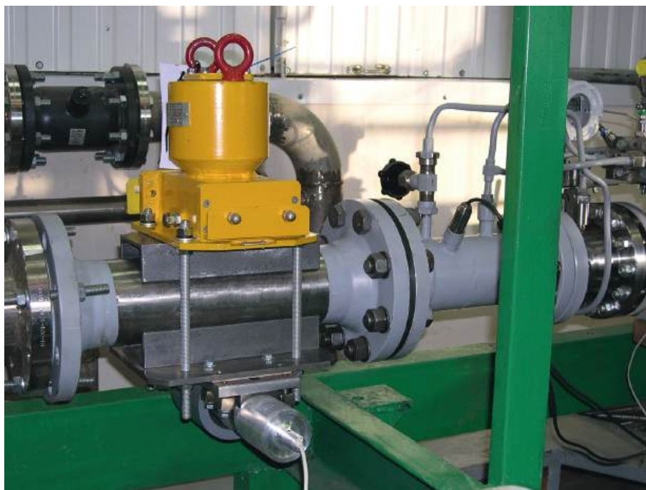
Рис. 9. Внешний вид макета двухизотопного \gamma -плотномера DN 100 во время испытаний на стенде многофазных потоков ГЭТ195-2011, ВНИИР (г. Казань).
