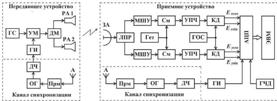
Рис. 2. Структурная схема экспериментальной установки радиофизического комплекса: ГС – генератор сигналов СВЧ на частоте 9.3 ГГц, УМ – усилитель мощности, ДМ – делитель мощности, РА 1 – рупорная антенна горизонтальной поляризации, РА 2 – рупорная антенна вертикальной поляризации, А – антенна для приема GPS-сигналов, Прм – приемник GPS-сигналов, ОГ – опорный генератор FS725, ДЧ – делитель частоты, ГИ – генератор прямоугольных импульсов Г5–63, ЗА – зеркальная антенна трехантиметрового диапазона, ЛПР – линейный поляризационный разделитель, МШУ – маломощный усилитель, См – смеситель, Гет – гетеродин типа Г4–83 на частоте 8.85 ГГц, УПЧ – усилитель промежуточной частоты, КД – квадратурный демодулятор, ГОС – генератор опорного сигнала на частоте 450 МГц, АЦП – аналого-цифровой преобразователь, ЭВМ – электронно-вычислительная машина, ГЧД – генератор частоты дискретизации Г4–158 на частоте 90 МГц, E_{xcos} , E_{xsin} , E_{ycos} и E_{ysin} – квадратуры сигналов ортогональных составляющих E_x и E_y .
