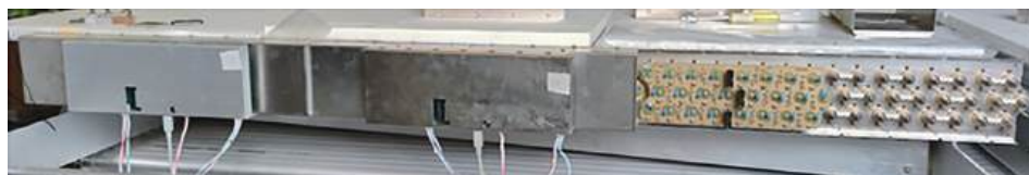
Рис. 7. Торцевая часть камеры с сигнальной стороны (сняты одна переходная плата и плата MT-48).
